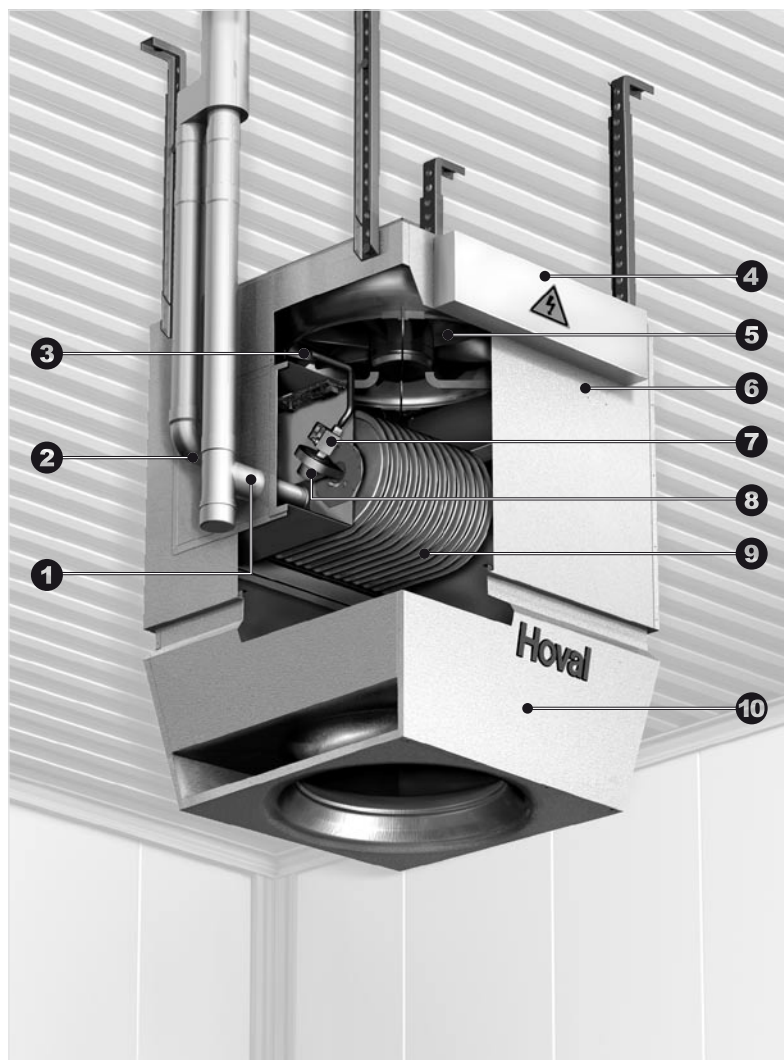
Bild C2-2: Aufbau des TopVent® NGV
